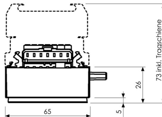
EM Umrüstsatz 1528mm 60°, flexibel + werkzeuglos positionierbar auf EM TRAGSCHIENE, weiss lackiertes Stahlblech, Abdeckung Linse, elektrisch steckbar, optional mit Litzen und Schneidekontaktclips für bestehende Durchgangsverdrahtung 1.5mm<sup>2</sup> oder 2.5mm<sup>2</sup>, Leistungsstufen wählbar per DIPSWITCH, Phasen (L1, L2, L3) frei wählbar
