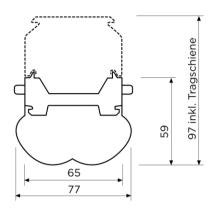
FAST LINE LED LEISTE 1405 130°, flexibel und werkzeuglos positionierbar auf FAST LINE TRAGSCHIENE, weiss lackiertes Stahlblech, Abdeckung Linsenoptik, durchgängig integrierte 13-Polige Verkabelung, Konverter intern
