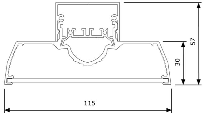
Einzelleuchte TIRO 1500, farblos eloxiertes Aluminiumprofil, Abdeckung opal clickbar, Netzanschlussklemme, Montage Pendel mit Drahtseilaufhängung oder Anbau mit Schrauben (bauseitig), Konverter intern
